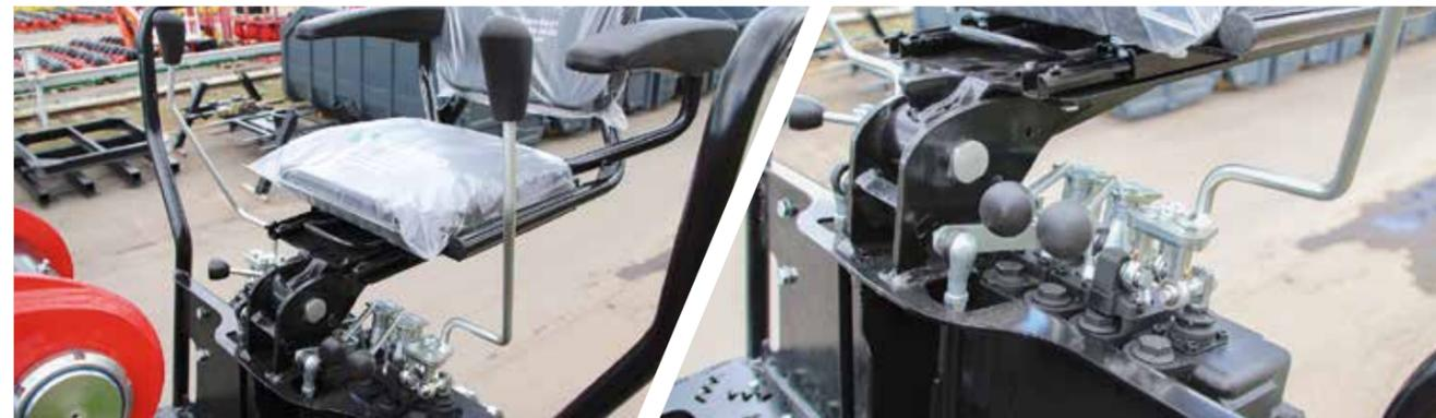
Механизм управления состоит из двух педалей и двух рычагов, а также из 3-х дополнительных рычагов, которые позволяют управлять аутригерами во время работы на манипуляторе.
