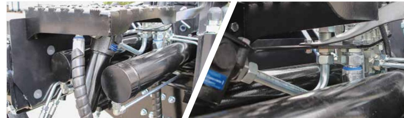
Напорный фильтр располагается на левой площадке ОПУ. Порт подключения имеет внутреннюю резьбу G3/4".
