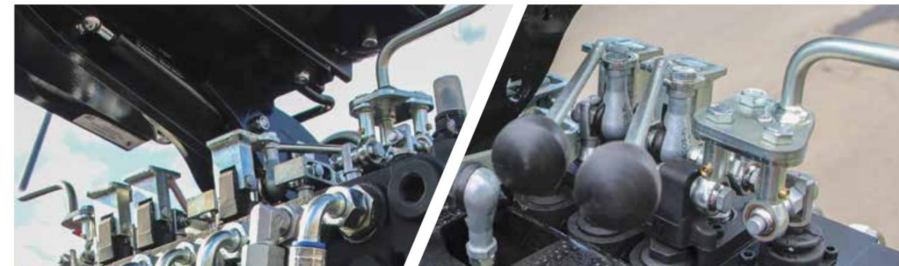
В конструкции рычагов управления используются угловые шарниры открытого типа, с помощью которых рычаги крепятся к золотникам напрямую, без использования промежуточных тяг. Это позволяет снизить риск появления люфтов в механизме и повысить точность управления манипулятором.
