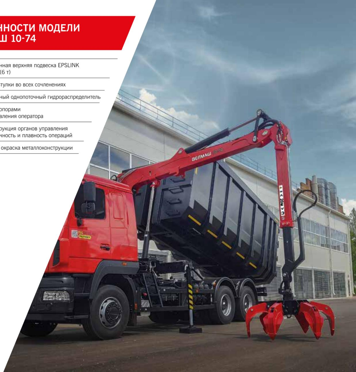
Все манипуляторы производства ВЕЛМАШ с мая 2022 года имеют порошковую окраску основных металлоконструкций. Это позволяет значительно повысить степень защиты от механических повреждений и атмосферных воздействий.
