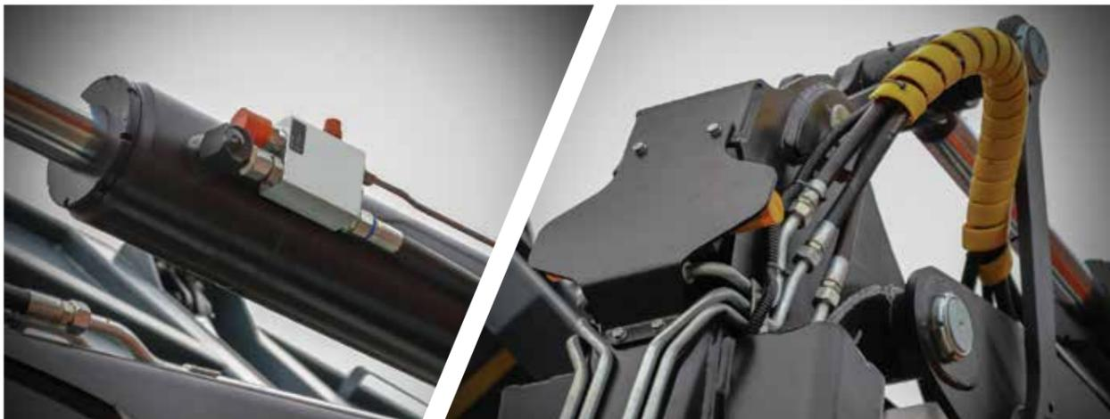
Манипулятор оборудован гидрозамками, исключающими самопроизвольное опускание стрелы в случае повреждения РВД.
