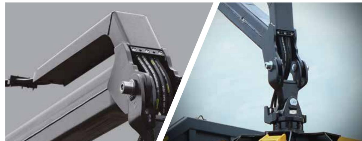
Диаметр трубопроводов и РВД рассчитан оптимально. Специально разработанный кожух надежно защищает РВД на удлинителе от внешних механических повреждений.
