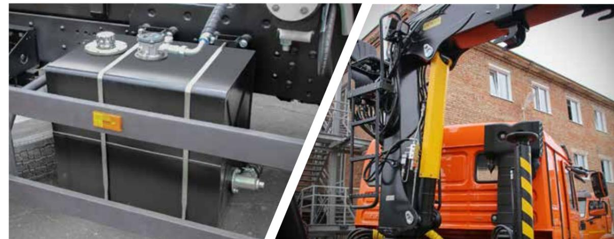
Увеличенный объем бака исключает перегрев масла даже при работе в период высоких плюсовых температур окружающего воздуха.
