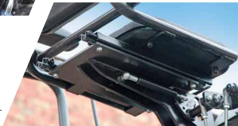
Кресло оператора имеет продольную регулировку (к колонне – от колонны) и может быть отрегулировано под конкретного оператора.
