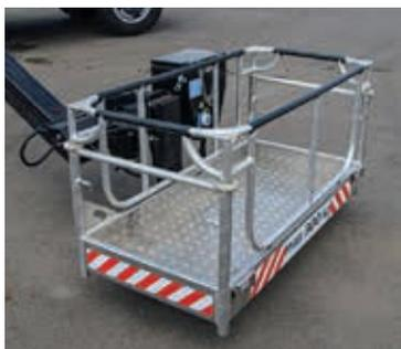
Боковое крепление корзины к оголовку стрелы SF и складные поручни обеспечивают минимальную высоту машины в транспортном положении.
