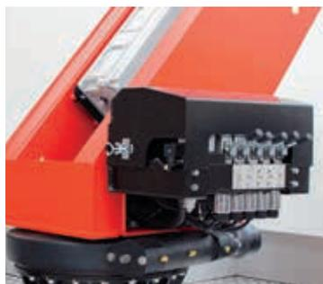
На гидрораспределитель подъемника установлен быстросъемный кожух, обеспечивающий защиту и быстрый доступ к органам аварийного управления.
