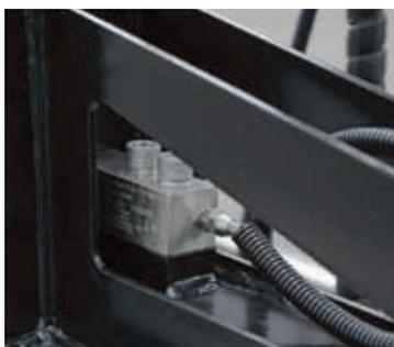
Система ограничения предельного груза построена на базе тензодатчика, который обладает большей точностью и стабильностью в работе.
