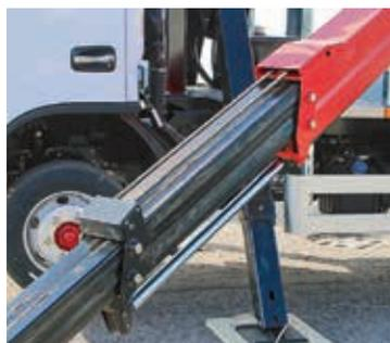
Цепная синхронизация выдвижения стрел обладает большей надежностью и долговечностью по сравнению с тросовой.
