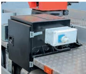
Ящик для размещения гидрооборудования с внутренними компонентами (аварийный насос, панель управления аутригерами) установлен справа по борту шасси.
