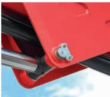
Все оси имеют тройное крепление - шпонка, пружинное кольцо, самоконтрящаяся гайка и масленки для обслуживания.
