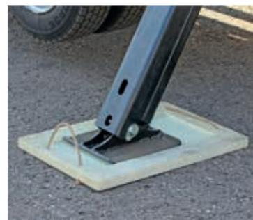
Подкладки из синтетического материала с направляющими для быстрой установки обеспечивают сохранность дорожного покрытия и надежную фиксацию опор при работе автогидроподъемника.
