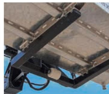
Специальные капролоновые проставки под полом корзины обеспечивают электроизоляцию до 1000 В. Ролик в нижней части узла крепления предохраняет корзину от удара о землю.
