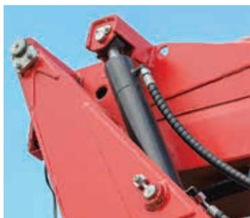
Регулировка горизонтирования автоматическая (перетечка рабочей жидкости в двух цилиндрах), нормальное положение клапана – закрытое, открывается при увеличении давления.
