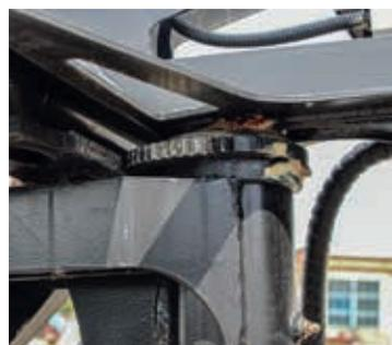
Металлическая шестерня и рейка поворота корзины обеспечивают надежность и четкую работу конструкции.
