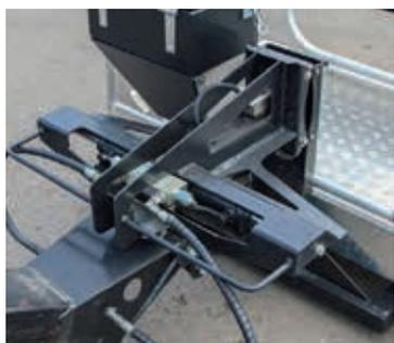
РВД и провода защищены. Электропроводка и шланги гидравлики расположены внутри стрелы.
