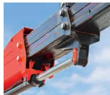
Гидроцилиндр телескопирования расположен снаружи и снизу стрелы, что обеспечивает достаточную защиту без необходимости увеличения сечения стрел.
