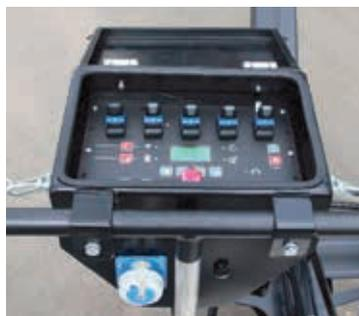
Электрогидравлическое управление АГП имеет два пульта: верхний закреплен в корзине в металлическом ящике, второй пульт управления с радиоканалом и кабелем длиной 10 метров. Так же на пультах расположен счетчик моточасов. В штатную комплектацию входит удлинитель с 2-мя розетками 220В, в корзине и на шасси.
